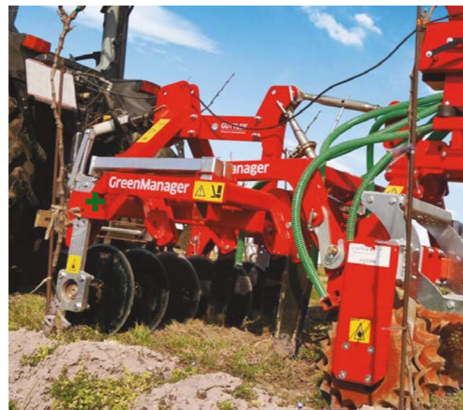
Le cultivateur passe sous la végétation sans mélanger la terre. Le sol reste recouvert : économie d'eau et protection contre l'érosion !
